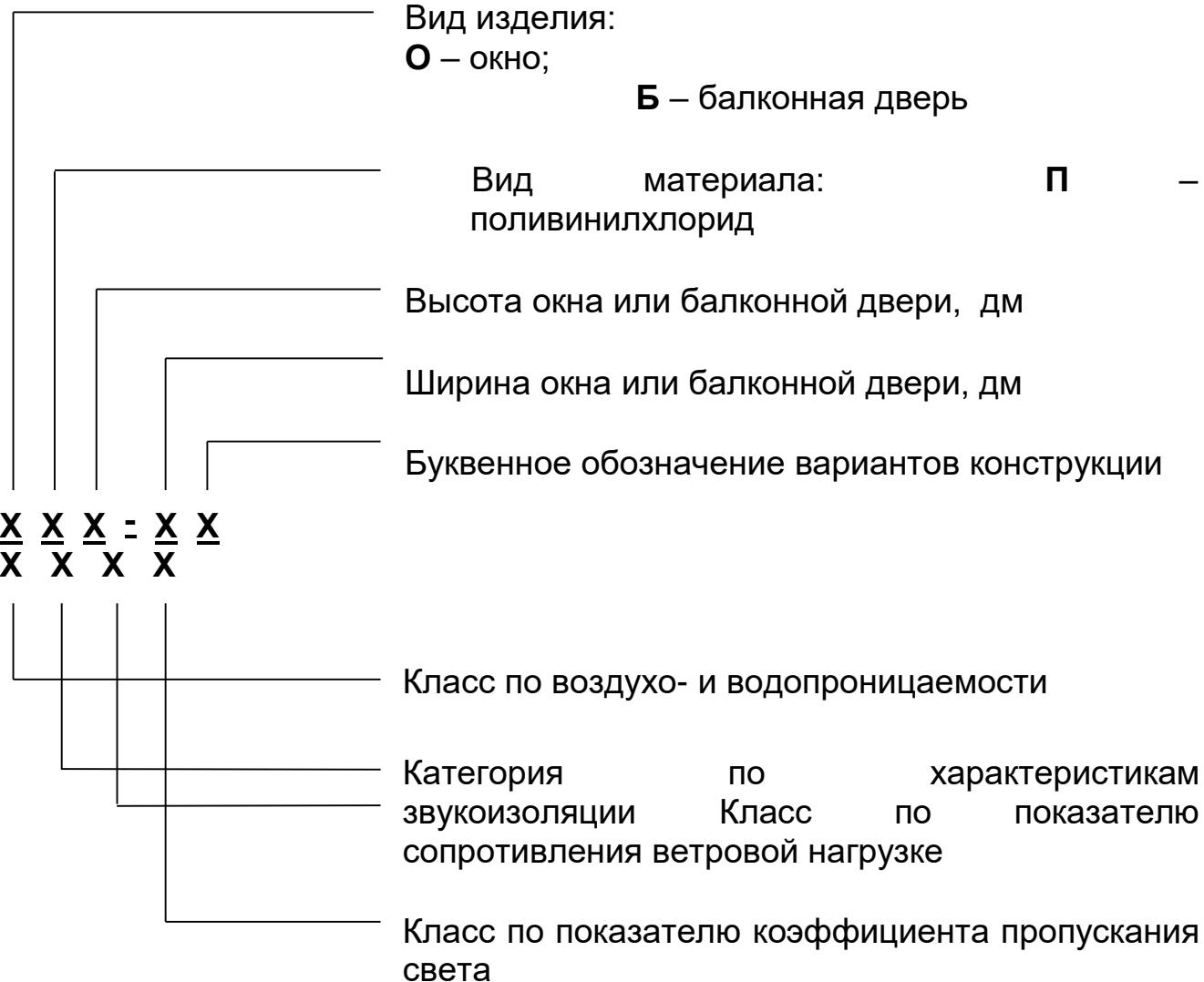
Обозначение вариантов конструкции:
